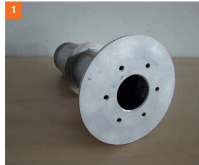
Durchdringung aus Edelstahl, Flanschbreite mind. 50 mm.
